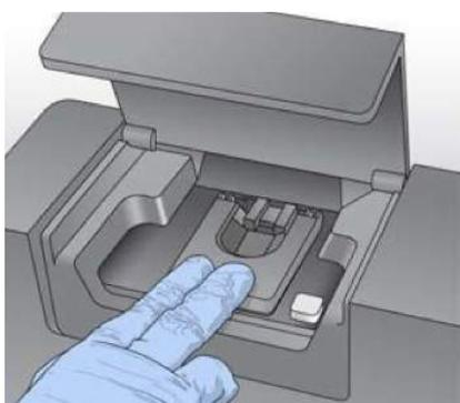
Рис.16. Закрывание защелки проточной кюветы
