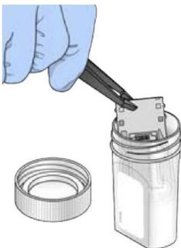
Рис. 10. Извлечение проточной кюветы
