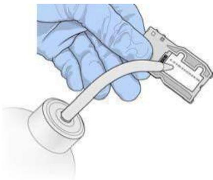
Рис. 11. Промывка проточной кюветы
