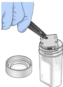
Рис. 10. Извлечение проточной кюветы
