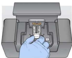
Рис. 15. Установка проточной кюветы на столик
