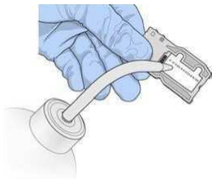
Рис. 11. Промывка проточной кюветы
