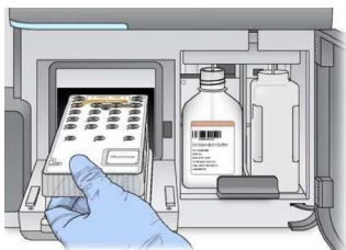
Рис.19. Загрузка картриджа с реактивами
