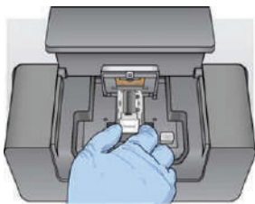
Рис.15. Установка проточной кюветы на столик
