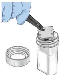
Рис.10. Извлечение проточной кюветы
