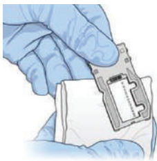
Рис.13. Сушка проточной кюветы
