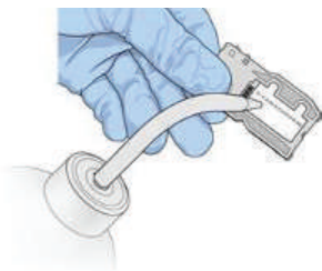
Рис.11. Промывка проточной кюветы
