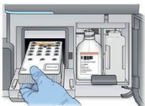
Рис.19. Загрузка картриджа с реактивами
